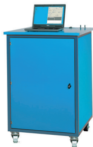
Équipement mobile permettant de réaliser le test des filtres HEPA et d'en interpréter les résultats en direct
